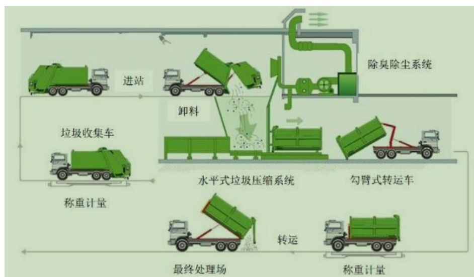
图 5-3 营运期压缩工艺流程示意图
