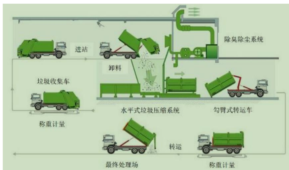
图 5-3 营运期压缩工艺流程示意图
