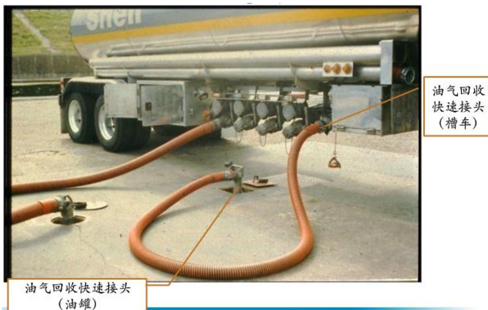
图 1-3 一次油气回收实例图
